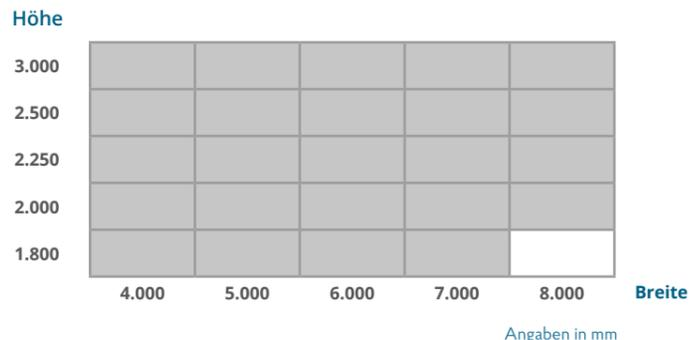
Min. Pfostenhöhe 1.470 mm, hier Dimensionen für Füllung Stab 30 x 30. Weitere Füllungen auf Anfrage.
